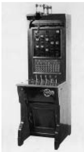
c) Induktorska telefonska centrala iz 1895. g. Proizvod Tvornice "Deckert i Homolka", Budimpešta Ovo je najstariji tip telefonske centrale koji se koristio u javnom prometu.
