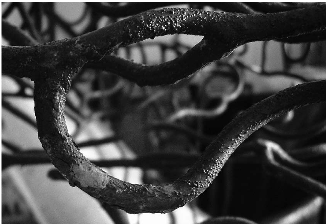
sl. 2. Majkus, Siniša: Stolica Newton – Wilson Detalj oštećenja: na mjestu gubitka završnog premaza vidi se uznapredovala korozija
